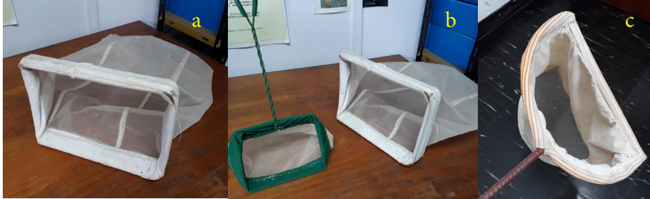
Fig. 7.3. Fig. 7.3. a. Red Surber para muestreo de organismos bentónicos en ríos (macroinvertebrados acuáticos). b. Red Surber modificada para ríos pequeños (marco verde) y Surber común. c. Red "D" o red de pateo (kicking net) para muestreo cualitativo o semicuantitativo. Fuente: Cátedra de Ecología General (Fac. Cs. Agrarias, UNJu).
