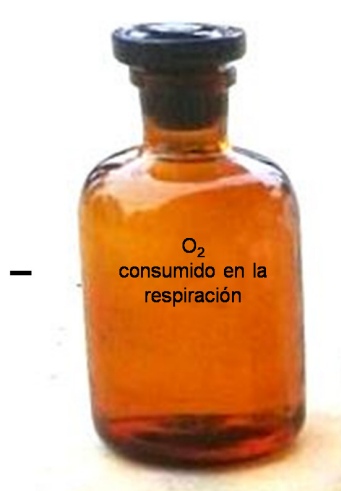
Fig. 4.1. Método de la botella clara/oscura para la evaluación de la producción primaria neta en ecosistemas acuáticos. Fuente: elaboración propia. Cátedra de Ecología General (Fac. Cs. Agrarias, UNJu)
